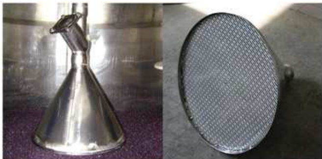
Fig. 3: Particolare della valvola di ritegno collegata ad un cono munito di griglia di protezione.
