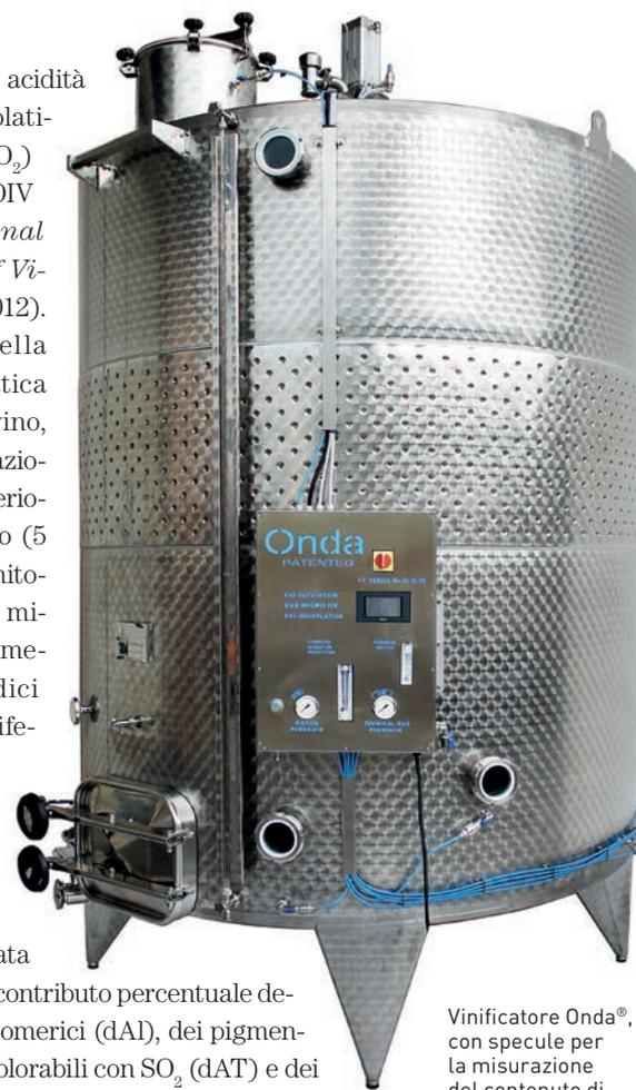
Vinificatore Onda®, con specule per la misurazione del contenuto di ossigeno disciolto nel mosto/vino [Fonte <http://www.ghidimetalli.it/>]
