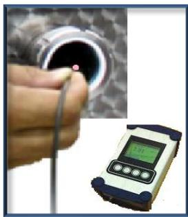
**Figura 5.4:** NormaSense, misurazione dell'ossigeno.
